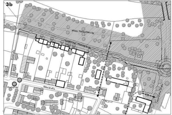
Variante mit geschlossener Bebauung entlang der Nordspange, stark verlärmter Bereich schraffiert, links: ohne Lärmschutzwand, rechts: mit Lärmschutzwand.
